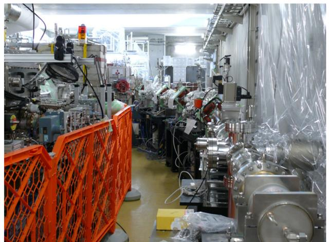
図4 着々と設置が進められている電子銃と入射部超伝導空洞の電子ビーム評価ライン（ビームダンプを含む）のビームライン。
