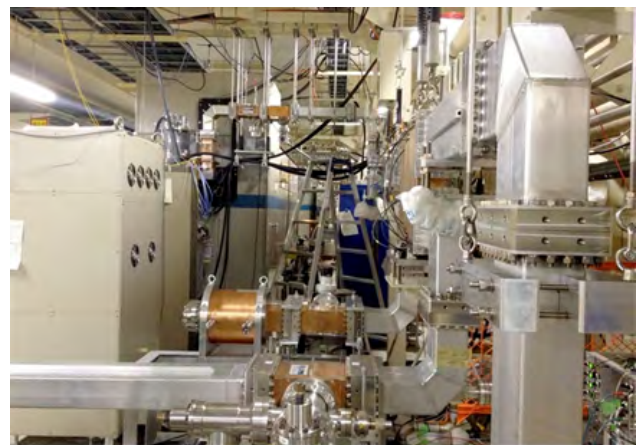
図4 Lバンドクライストロンなどのマイクロ波源地上側設備。
