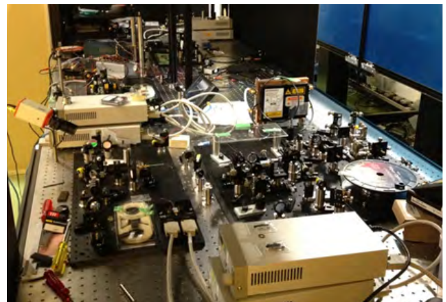
図1 Ybファイバ・レーザ発振器とファイバ・レーザ増幅器。
