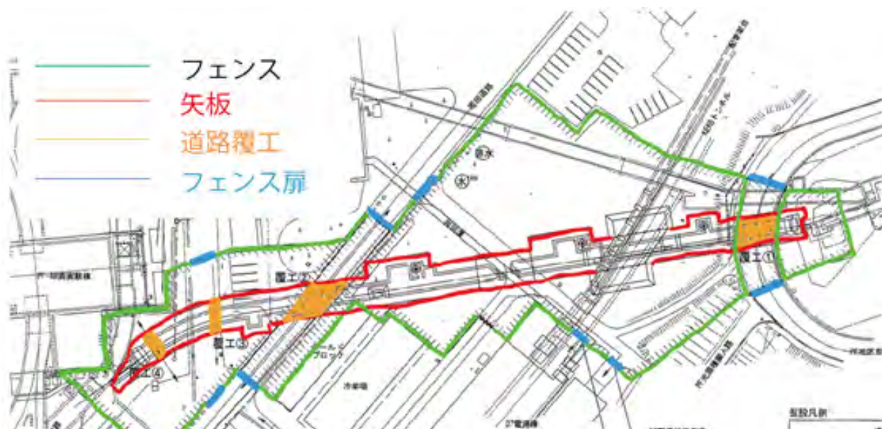
図2 PF-AR 直接入射路および工事エリア。赤線で示したところが矢板をする新トンネル部分、緑線が工事境界のフェンスで囲まれる部分、水色部分がフェンス扉、橙色で塗られた部分が道路覆工場所で、建設工事期間中支障がない限り通行可能にする部分。
