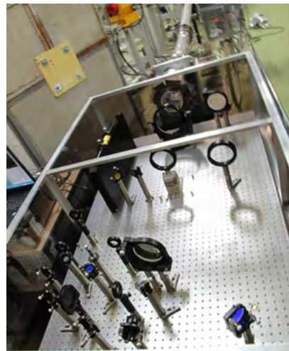
図5 開発されたレーザー光学系（C-5 セクタ用）。レーザー（He-Ne: 10 mW）は光学系（大気）で全幅約 1 mm から約 40 mm に拡大された後、手前から後方へ伝送し光軸管（真空）に入る。
