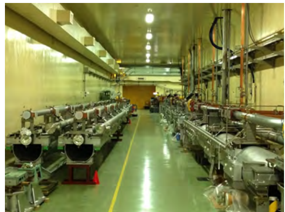
図2 陽電子生成部再構築のために撤去・移動された加速管架台(左側)。
