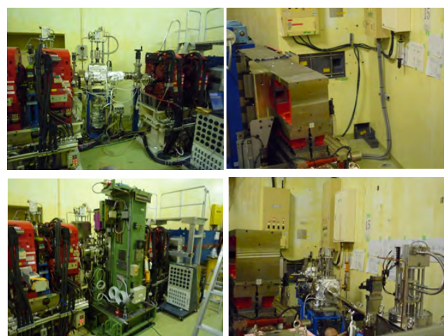
図2 新ビームラインBL-15のアンジュレータの設置前(左上)と設置後(左下)と基幹チャンネルの設置前(右上)と設置後(左下)。
