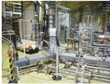
図1 冷却水漏れを起こしたサーキュレータを交換しているところ(上図)と新規製作のサーキュレータに交換完了したところ(下図)。
