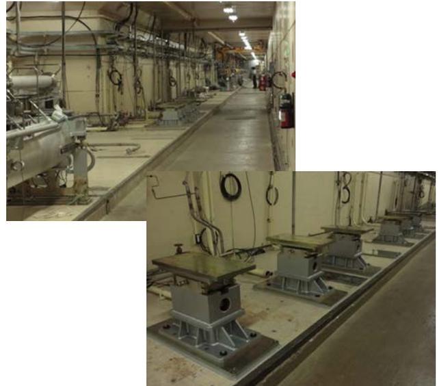
図1 撤去された陽電子生成部と、重量のある新規陽電子生成部（ユニット #16）の架台脚。
