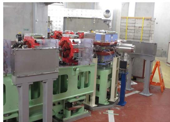
図 3 周回部から発生する可能性があるビームロスに備えた周回マグネット近傍に設置した放射線シールド。
