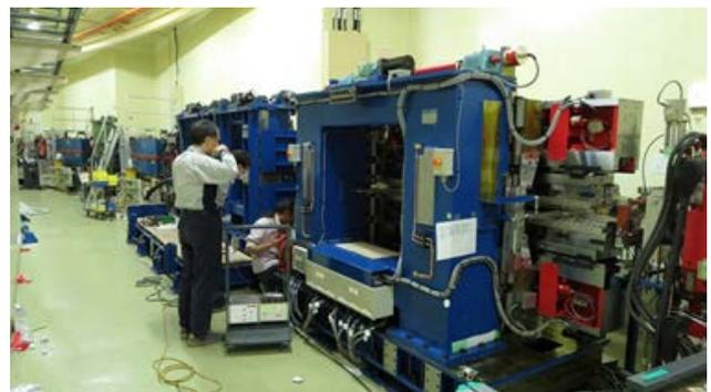
図2 PFリング北直線部に設置された可変偏光アンジュレータU#02-2(右)。下流に設置されているのが、既設アンジュレータU#02(左)。
