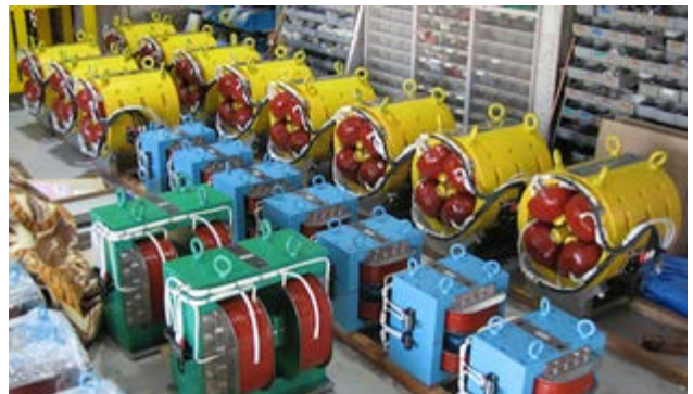
図5 新規に製作された4極電磁石(黄色)、垂直偏向電磁石(水色)とステアリング電磁石(緑色)。
