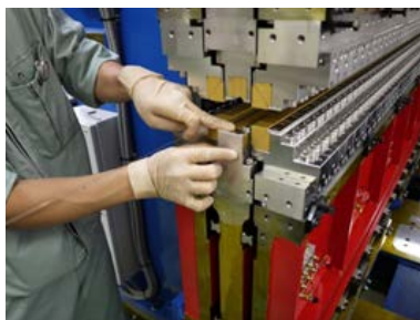
図 1 (上図) U#28 の磁場調整中の写真。(下図) U#28 (6 列型) 端部チップ磁石による多極成分補正を行っている様子。
