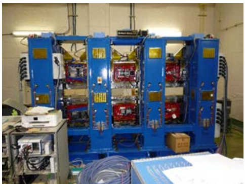
図3 磁場調整を終了した搬入待機中のU#13(上:APPLE-II型可変偏光アンジュレータ)とU#28(下:六列型可変偏光アンジュレータ)。
