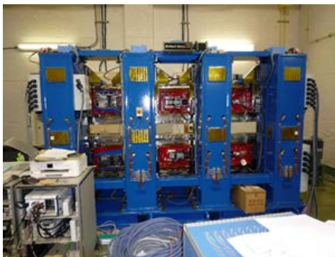
図3 磁場調整を終了した搬入待機中のU#13(上:APPLE-II型可変偏光アンジュレータ)とU#28(下:六列型可変偏光アンジュレータ)。
