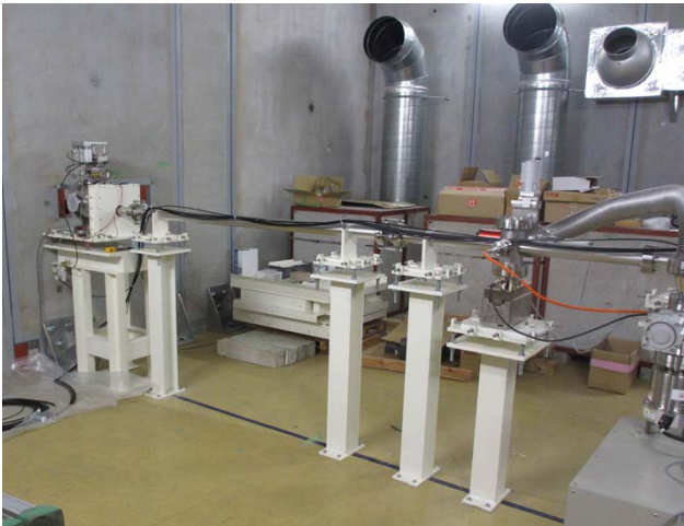
図3 放射線シールド内のビームシャッターを含むビームラインの様子。
