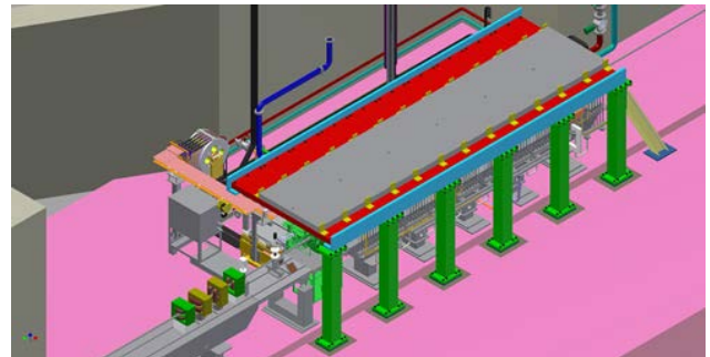
図3 現在の陽電子生成装置とそれを覆う遮蔽の設計。
