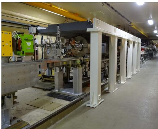
図1 陽電子発生装置（上）と、その上に設置された遮蔽（下）。現在の遮蔽は鉄 20 cm。
