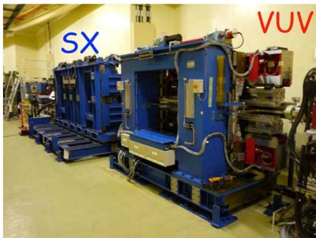
図2 BL-2長直線部に設置された真空紫外(VUV)用および軟X線(SX)用アンジュレータ。
