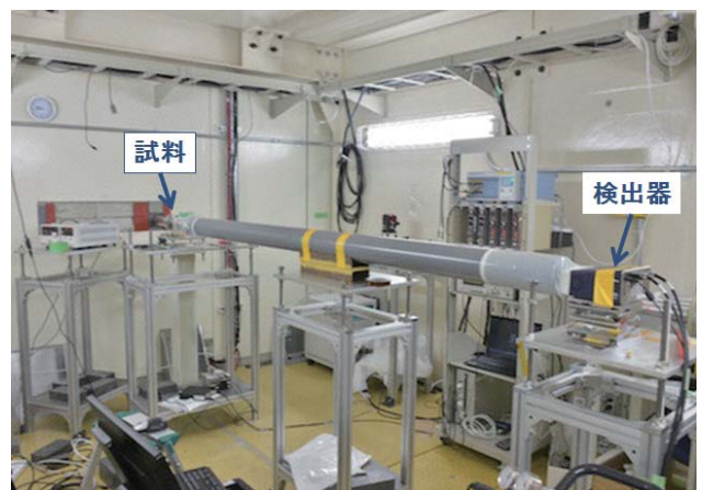
図2 微小光源である LCS 光源によるイメージングの特徴である屈折イメージングを取るために試料と検出器は 2.5 m の距離を置いて撮影。そのような条件でも検出器の空間分解能（100 \mu m）を保っている。
