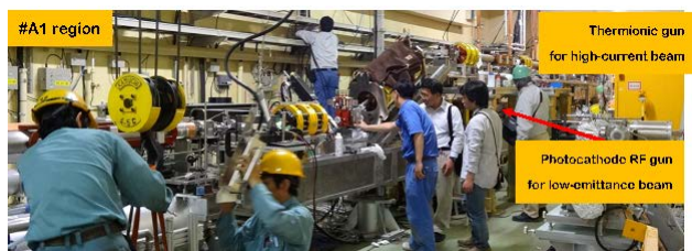
図5 電子銃部再配置作業終盤、ビームラインの上段が上方に移動した熱電子銃、下段がRF電子銃。
