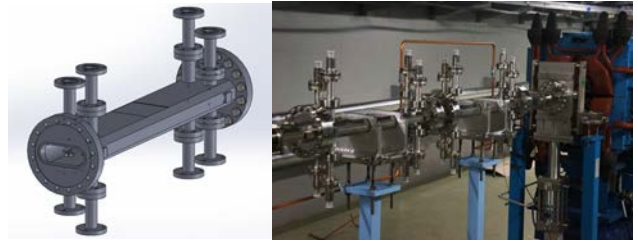
図 1 フィードバックキッカーの 3D CAD（左図）、リングに設置した写真（右図）
