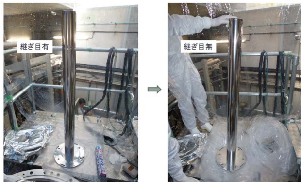
図 1 接続したカソードロッドと新規製作した一体のカソードロッド。
