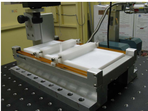
図5 (上) 現在の BL-18B ハッチ内を下流側からみた様子。写真奥(上流側)に見える \gamma サークルと 2 \theta アームが第一回折計, 手前(下流側)にみえる大きなステージをもつ回折計が第二回折計。(下) 第二回折計上に液体試料を設置するためのステージ, 写真では除振台の上に LB 膜作成用のトラフが実装されている。
