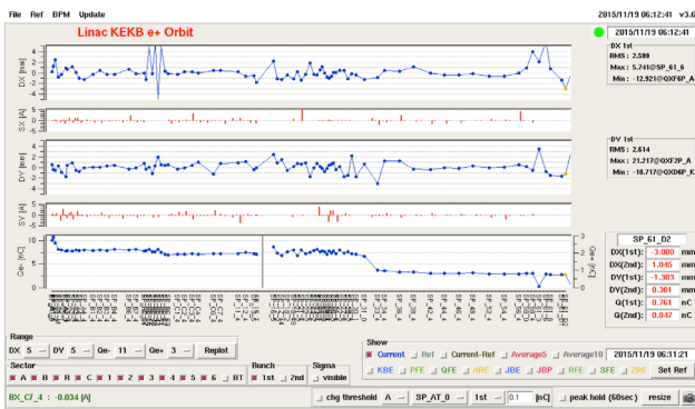
図3 陽電子輸送の様子。中央左が陽電子標的，中央右のダンピングリング接続部まで約 2 nC，入射器終端まで約 1 nC の陽電子ビームを導いている。
