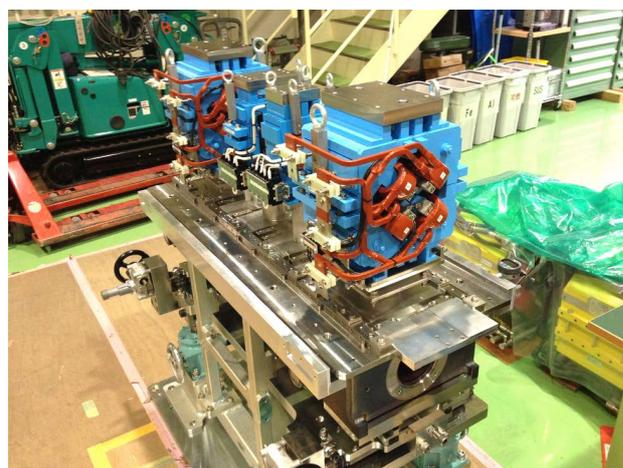
図5 新しく設計した架台に乗せられた4台のパルス電磁石
