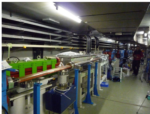
図4 PF-ARの入射点：入射路上流からDCセプタム1台とパルスセプタム2台が設置された。
