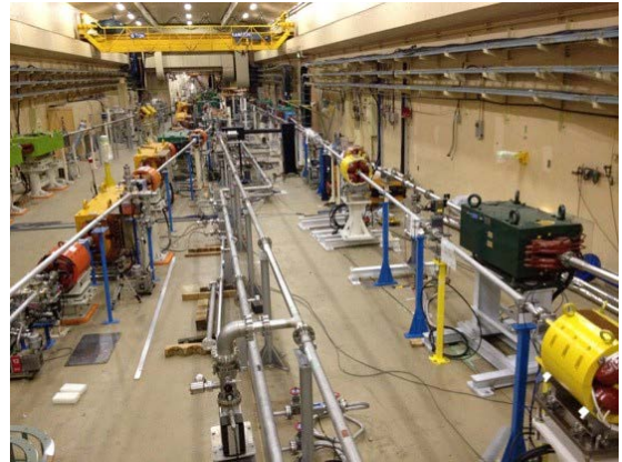
図 2 入射器終端の第 3 ビーム・スイッチ・ヤード。右から、PF リング、PF-AR、直線ダンプ、SuperKEKB LER（陽電子）、HER（電子）、東ダンプ、の各ビームライン。
