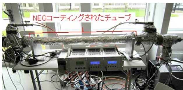
図 3 Tutorial で使用した真空システム
