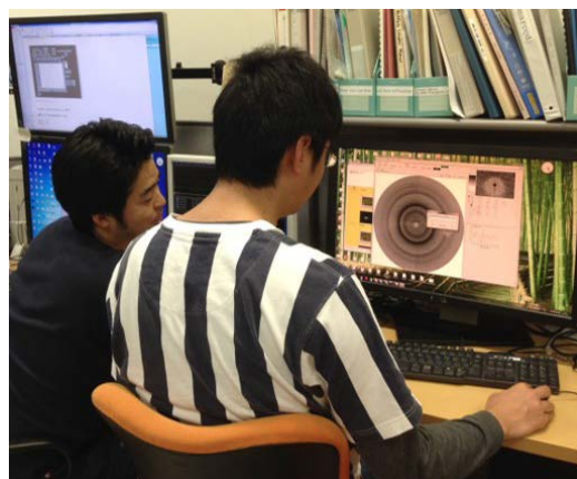
図 2 一柳先生（左）と共に、標準試料の X 線回折パターンからカメラ長測定を行なっている著者（右）
