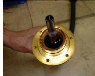
図7 故障した HOM ケーブルの端のコネクタ (ダミーロード側) を外したところ。絶縁体のポリエチレンはよりひどく変色し溶けていた。
