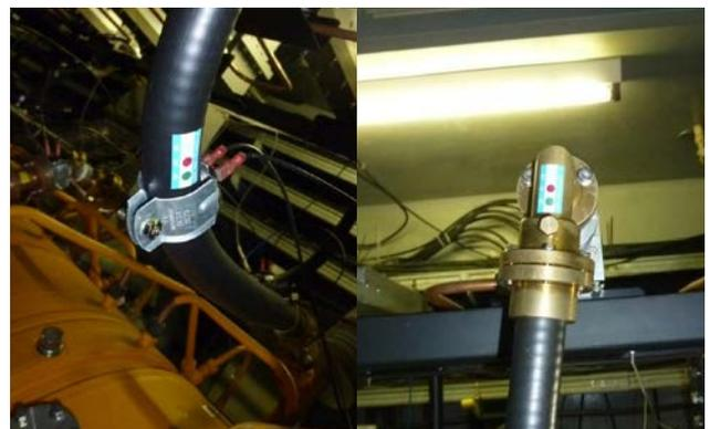
図9 故障した HOM ケーブルのサーモラベル表示。(左) 中央部、(右) ダミーロード側。いずれも50°C以上を示す赤色と60°C以上を示す緑色のサインが表示されていた。
