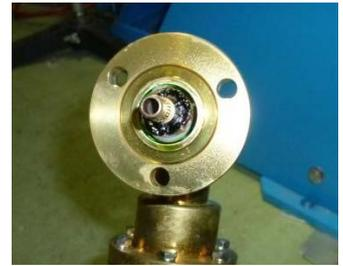
図6 故障した HOM ケーブルに付属する L 型アダプタ (ダミーロード側)。絶縁体のポリエチレンが黒色に変色していた。
