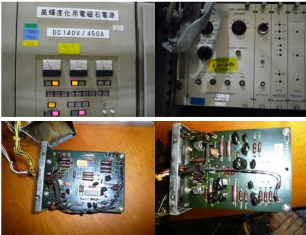
図2 PFリング立ち上げの5月7日に故障したSFD(6極電磁石: 1994年製造)電源。上右図の黒いダイヤルが3つについているモジュールが故障したモジュールで、下図がモジュール内部の基板。内部基板は焦げ、抵抗2個破裂、配線も焦げているのが分かった。
