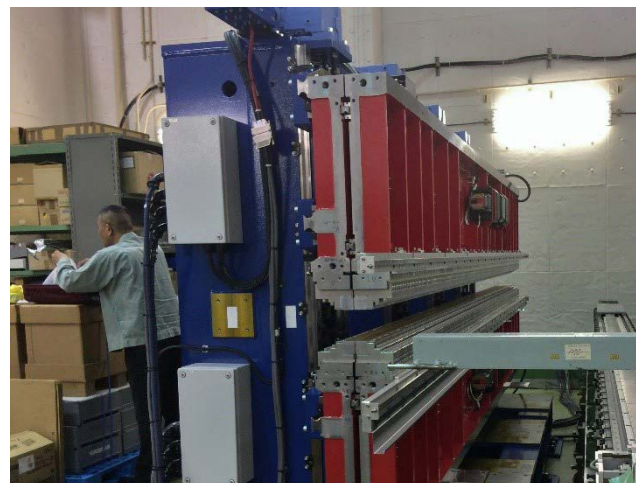
図3 PF-AR北棟挿入光源準備室で磁場調整中の新しいアンジュレータ(U#19)
