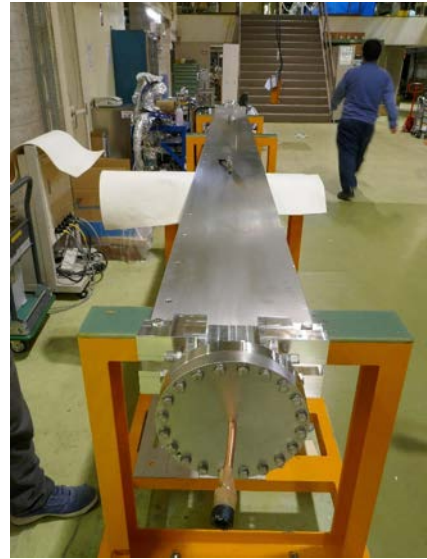
図2 内面にNEGコーティングされたU#19用の新しい真空チャンバー
