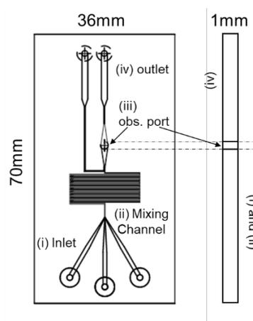
図3 自動サンプリング用μ流路デバイス
