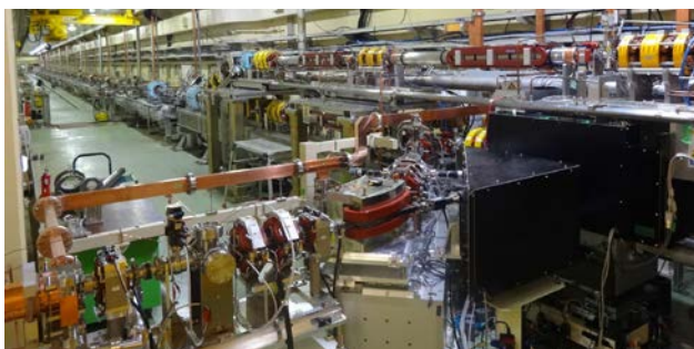
図4 入射部の現在の様子。合流部近辺の水色の電磁石が最近設置されたパルス電磁石。
