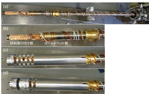
図4 (a) He フロー型冷凍機の全体像。(b) 試料・コールドヘッド部の拡大図。放射シールドを取り付けた状態で、開いているX線窓の数が(c)5か所。(d)3か所。
