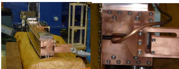
図 3 新規に製作されたセプタム電磁石 (S2) の全体 (上図) および断面の写真
