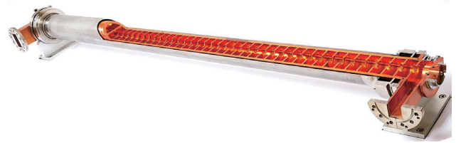
図2 縦に切断して断面が見えるようにした2mの2/3πモード定加速勾配進行波型加速管。
