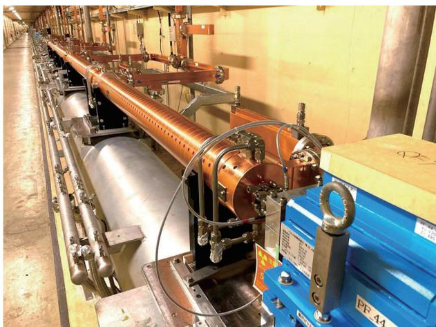
図 3 #44 ユニットに設置された 4 本の新規の加速管
