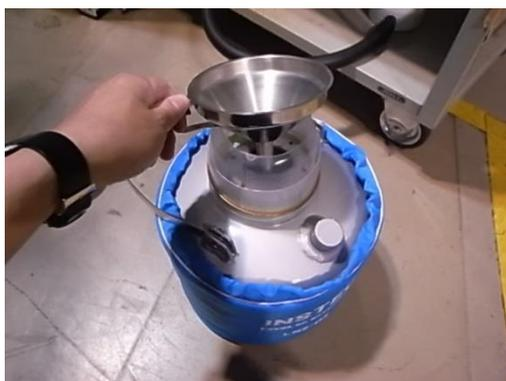
・付属のデュワー瓶で、ステージ本体の温度が室温～100℃の利用であれば、液体窒素は約 24 時間持ちます。
