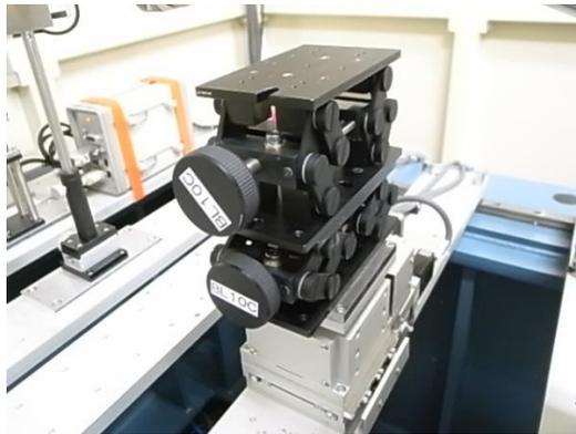
•枠の開口部は、人が通常アクセスする側となります。以下の写真はイオンチャンバーが省略されています。100℃以上に昇温する際は、ステージ本体とノーズ、ステージ本体とイオンチャンバーを20mmくらい離してください。それ以下の場合にはステージ本体の出し入れに支障がない程度に近づけてください。
