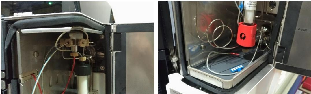
接続後に、流速を元に戻してカラム平衡化を開始。
