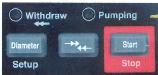
送液中に点灯していた Pumpingのランプが点滅
