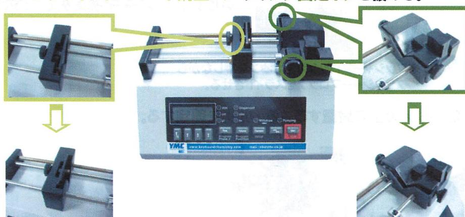
II. ①(ポンプ)のクランプを持ち上げ、1/4回転させる。
