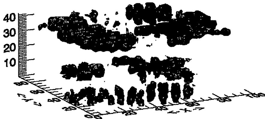
図 3: オーバーサンプリング法によって得られた Ni パターン試料の三次元像 [8]。各軸の単位は 25 nm。
