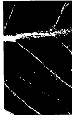
図4. BBB 干渉計により撮影されたクローバーの葉の位相マップ。
