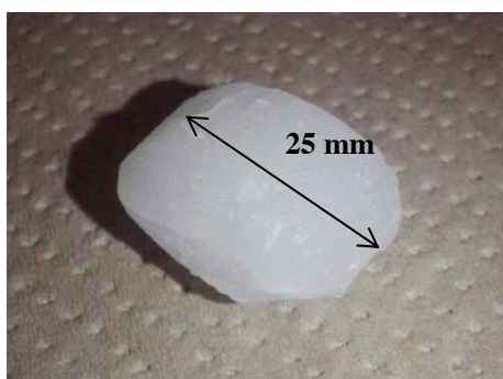
図1 大気圧下、 -20^{\circ}\text{C} の NGH ペレット
