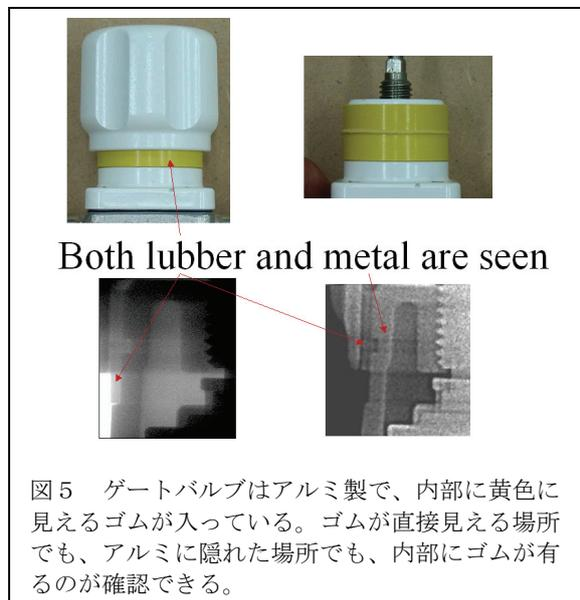
図5 ゲートバルブはアルミ製で、内部に黄色に見えるゴムが入っている。ゴムが直接見える場所でも、アルミに隠れた場所でも、内部にゴムが有るのが確認できる。
